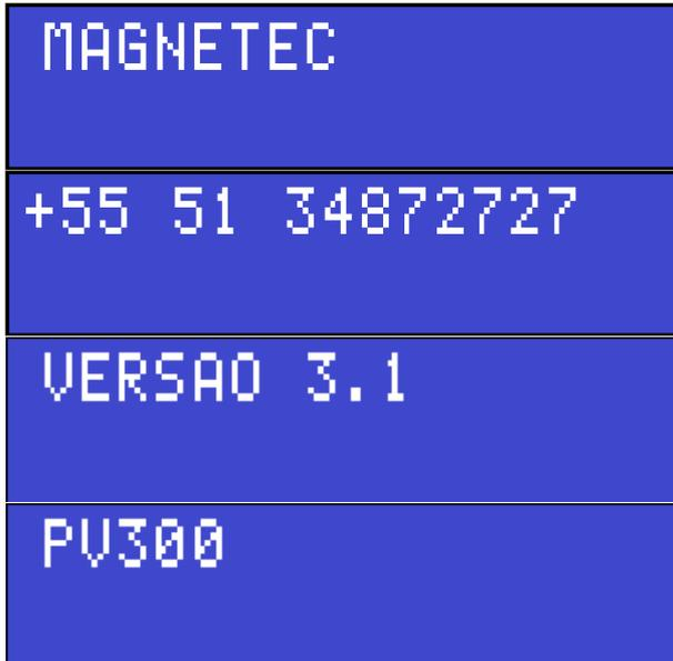
Quando você liga o detector de metais, ele precisa fazer uma série de ajustes internos. Enquanto esses ajustes são feitos, as telas acima são exibidas. Quando o equipamento terminar de fazer os ajustes necessários, a tela inicial será exibida e o equipamento entrará em funcionamento, acusando sempre que um metal for detectado.
