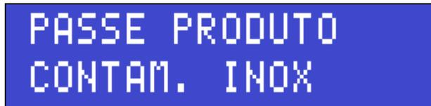
5. Retire o contaminante de ferro, acrescente o contaminante de inox e passe o produto novamente. Os LEDs *Indicator I, II e III* apagarão.
