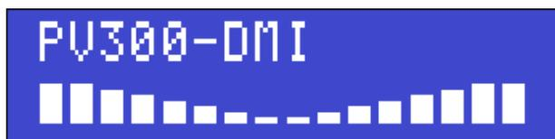
Para alternar entre os 2 tipos de bargraph, basta pressionar a tecla **confirmar** na tela inicial do equipamento. O equipamento vem configurado de fábrica para mostrar o bargraph horizontal.
