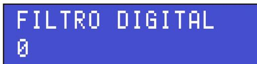
2. A linha inferior do display mostra qual o valor do filtro digital no momento. Utilize as setas no teclado para alterar o valor do filtro. Não é necessário utilizar a tecla **confirmar** ao trocar o valor, pois ele é aplicado automaticamente quando alterado através das setas do teclado. Aumente o valor do filtro até que o detector não apresente mais falsos alarmes. Passe a amostra do objeto que você quer detectar. Diminua o valor do filtro até que a amostra seja detectada.
