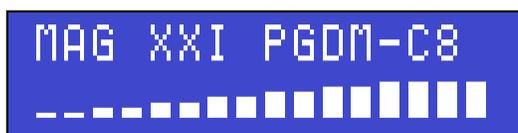
Para alternar entre os 2 tipos de bargraph, basta pressionar a tecla **confirmar** na tela inicial do equipamento. O equipamento vem configurado de fábrica para mostrar o bargraph individual por área.
