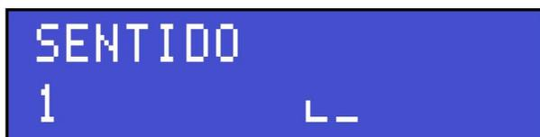
2. O número na linha inferior do display indica o número da passagem da amostra e o desenho ao lado representa a posição que o objeto deve ser passado. Passe o objeto em 3 posições diferentes, conforme a figura a seguir. Primeiramente, passe o objeto com o lado X voltado para o seu lado na altura do sinal luminoso, bem no centro do portal. Aguarde o sinal sonoro e aguarde aparecer o número 2 no display.
