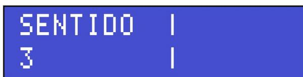
4. Repita o processo com o lado Z voltado para o seu lado. Quando você tiver passado a amostra 3 vezes pelo detector, ele emitirá um sinal sonoro diferenciado e o sinal luminoso irá desligar. A partir desse momento, todas as áreas tiveram sua sensibilidade alterada para o mesmo valor. Recomenda-se fazer um ajuste fino na sensibilidade manualmente para uma melhor detecção. Veja a seção **Sensibilidade** neste manual.
